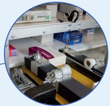
Control dimensional de envases por arco volumétrico
