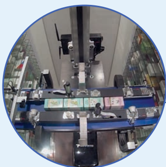
El cabezal trabaja a derecha e izquierda sin ningún tipo de giros ni cables molestos
