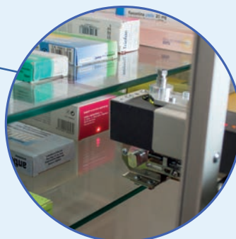
Control por barrido láser de envases almacenados
